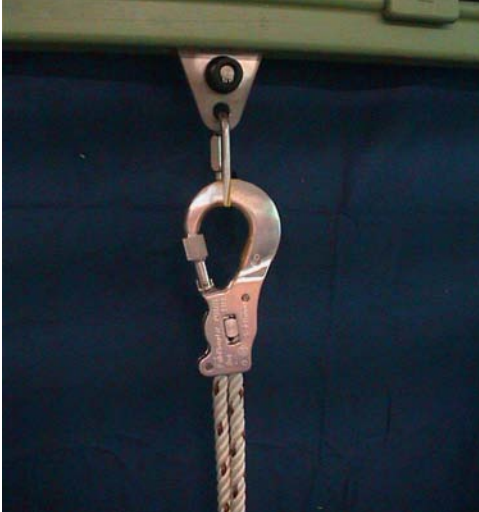
Bild 31: Anschlageinrichtung mit horizontaler Führungsschiene und beweglichem Anschlagpunkt
