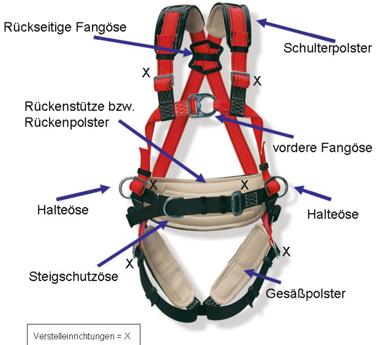
Bild 10: Beispiel eines Auffanggurtes mit vorderer und rückseitiger Auffangöse, seitlichen Halteösen und einer Steigschutzöse. Der Gurt ist zusätzlich mit Schulter-, Beingurt, und Rückenpolstern ausgestattet
