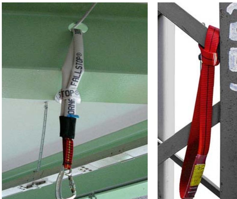
Bild 33: Beispiele für die Verwendung einer Bandschlinge als Anschlaghilfe
