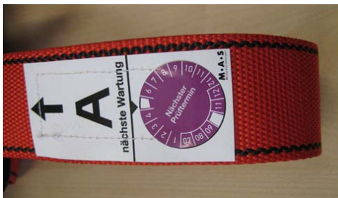
Bild 37: Beispiele für die Dokumentation der Sachkundigenprüfung auf der Schutzausrüstung
