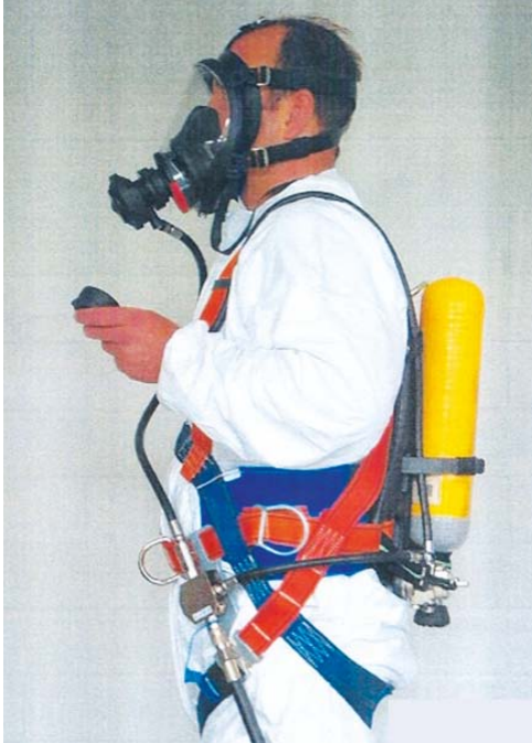
Bild 9: Beispiel eines Auffanggurtes mit integrierter Tragevorrichtung für Druckluftflaschen
