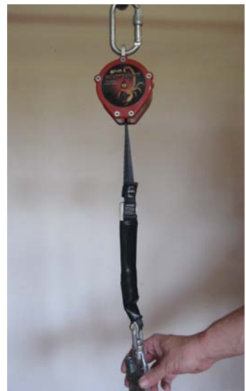
Bild 19: Höhensicherungsgerät mit Verbindungsmittel aus Gurtband
