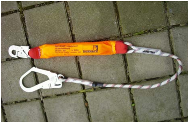
Bild 17: Verwendungsfertiger Aufreiß-Falldämpfer (Bandfalldämpfer) im Verbindungsmittel integriert
