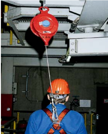
Bild 6: Beispiel eines Auffangsystems mit Höhensicherungsgerät
